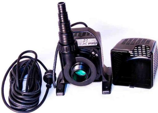
Bei diesem Pumpenmodell können Sie den Pumpenkorb abziehen. Dadurch legen Sie die Saugseite mit Aussengewindeanschluss frei. Somit können Sie einen Schlauchstutzen für den Saugschlauch des Skimmertopfes schnell und sicher montieren. Sie sehen nun selber, dass Skimmer eine hohe Pumpenleistung benötigen und dass man die Skimmeranlage auf keinen Fall mit dem eigentlichen Teichfilter kombinieren sollte.
