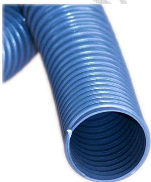
Dieser Spiralschlauch ist ideal passend zu unseren grünen Teichfilteranschlüssen mit 50 mm Schlauchtülle. Die passende Schlauchschelle dazu wäre die mit 40-60 mm Spannbereich. Aussen ist der Schlauch gewellt und Innen schön glatt. Man kann diesen Schlauch um 180 Grad biegen, ohne dass sich der Querschnitt verjüngt, da eine Hartspirale für die nötige Stabilität sorgt.
