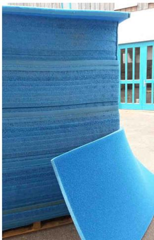
Hier sehen Sie die Filterplatten in 5 cm dicke Scheiben geschnitten. Diese werden dann mit speziellen Bandsägen weiterverarbeitet, bis das gewünschte Endprodukt fertig ist. Diese *Koimatten müssen übrigens lichtgeschützt gelagert werden*, weil sie sonst ausbleichen und sich grünlich verfärben. Wenn eine Schaumplatte einen Grüntich hat wissen Sie dass diese nicht anständig gelagert worden ist.
