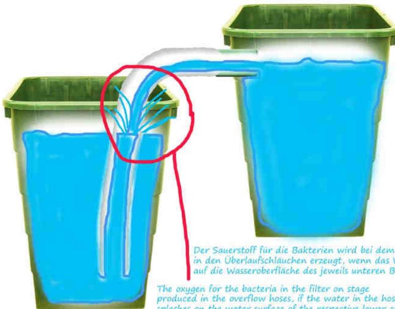
**Der Sauerstoff für die Bakterien wird bei dem Filter auf Stufen in den Überlaufschläuchen erzeugt, wenn das Wasser im Schlauch auf die Wasseroberfläche des jeweils unteren Behälters platscht!**
