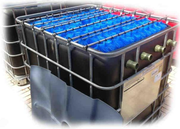
Die **zweite Filterkammer des K&K Filters ist nun fertig**. Diesen IBC Container können wir schon einmal am Stellplatz für den Teichfilter aufbauen. Mit 2 Personen kann man diesen, nur mit Bürsten gefüllten Tank, leicht tragen.
