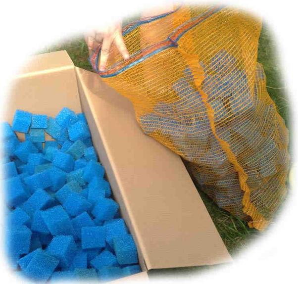
Die Filterwürfel müssen unbedingt in die Kunststoffnetze gefüllt werden. Sie können sich nicht vorstellen, wie aufwändig es wäre, die Würfel bei einer Reinigung einzeln aus dem Tank holen zu müssen. Auch bei der Reinigung bleiben die Würfel in den Säcken.
