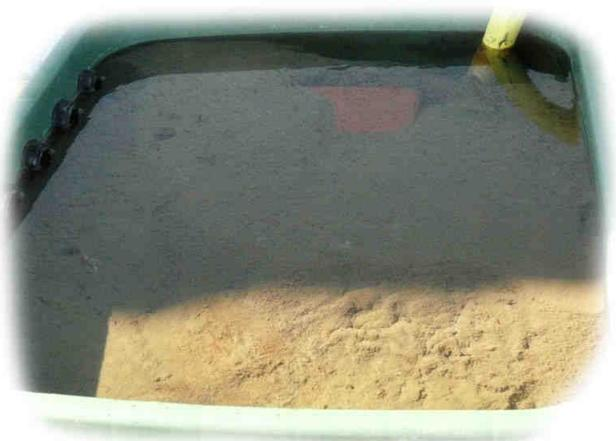
In diesem Fall hat sich der feine Schlamm und die Trubstoffe, wie gewollt, auch auf der Filtermatte angesammelt. Diese ist dadurch aber nicht verstopft und das Wasser kann trotzdem durch die feinen Poren des Schlamms hindurch. Der Schlamm reicht aber schon bis an die Anschlüsse der Überläufe. Jetzt ist es Zeit für die Reinigung. Hier sehen Sie auch **wie glasklar das Teichwasser im Filter** ist, da man den
