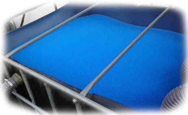
Legen Sie die 3 Filtermatten in den Container ein. Also alle 3 übereinander. Somit haben Sie eine ideale, feine Filtermöglichkeit geschaffen. Wenn Sie Schlitz in die Matten schneiden, können Sie die Überlaufschläuche durch die Schlitz leiten. Dadurch ist auch der Abschluss der Matte zu den Schläuchen gewährleistet. Legen Sie dann flache Steine (z.B. Ziegel) auf die Matten, damit diese nicht auftreiben können. Fertig ist die komplette Bestückung mit Filtermaterialien.
