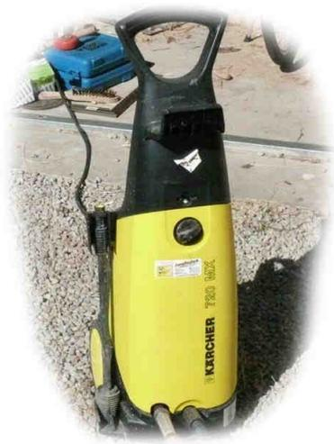
Zur Reinigung des Teichfilters ist der Hochdruckreiniger sehr praktisch. Verwenden Sie aber immer die einstellbare Variodüse. Die Dreckfräse wäre zu aggressiv für die Filtermatten. Für die Reinigung des groben Schlamms in den Regentonnen reicht aber der normale Gartenschlauch vollkommen aus.
