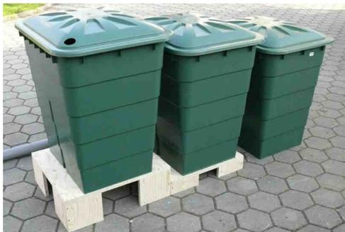
Egal ob für Teichfilter bis 50000 oder 30000 Liter. Ein Stufenunterbau muss für dieses Filtersystem auf jeden Fall installiert werden. Auf diesem Foto sehen Sie auch die Eingangsbohrung im Deckel der höchsten Tonne.
