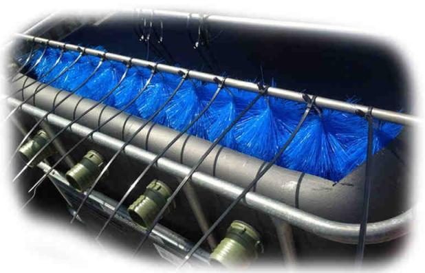
Da unsere Filterbürsten an einer Seite einen Haken haben, können wir diesen mit der Kombizange aufbiegen. Somit kann man die Bürsten mit kleinen Kabelbindern sicher an den Stahlstäben befestigen. Diese bleiben dann auch dauerhaft in Position und verschieben
