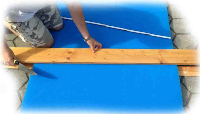
Die feinen Filtermatten schneidet man am Besten mit einem scharfen Küchenmesser zu. Nutzen Sie Bretter als Lineal und Unterlage. Somit können Sie saubere Schnitte ziehen. Lassen Sie beim Zuschnitt der Koimatten aber immer ca. 5 cm Aufmass. Die Matten können sich nach einiger Zeit nämlich noch etwas zusammenziehen. Die Matten sollen streng in die Filterkammer passen.
