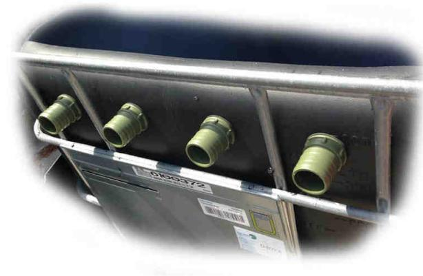
Hier sind alle 4 Anschlüsse mit 50 mm Schlauchtülle in einer Reihe perfekt angebracht. Somit nutzen wir das grösstmögliche Volumen des IBC Tanks aus. Optisch ist das ebenfalls eine wunderbare Lösung der Überlaufanschlüsse. Da auch die IBC Teichfilteranlage auf
