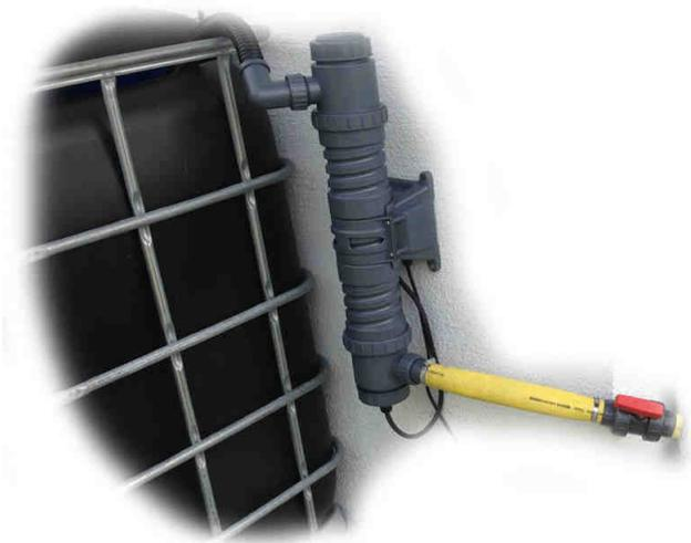
Der Kugelhahn vor dem UV-C Teichklärer ist zum Regeln des Durchflusses gedacht und zum Unterbinden des Rücksogs, wenn man nicht die Lösung mit dem T-Stück nutzen möchte. Der Schlauch von der UVC Lampe läuft im ersten IBC Container bis auf den Tankboden, damit das Wasser auch dort austreten muss, um nach oben durch die Filterbürsten laufen zu können.
