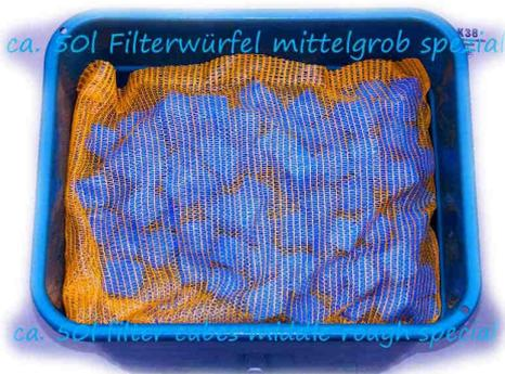
Dieser nur leicht mit Filterwürfeln gefüllte Netzsack wird ganz flach auf die Bürsten gelegt. Darin sammeln sich die Klärbakterien an und bauen schon mal in der groben Filterstufe die Schadstoffe wie Nitrat, Nitrit, Ammonium oder Ammoniak ab. Füllen Sie aber nicht mehr als 40-50l Würfel in den Sack ein, damit er nicht zu hoch wird. Die Filtermatte muss nämlich auch noch Platz darauf haben.
