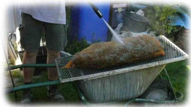
Mit der Variodüse des Hochdruckreinigers kann man das Filtermaterial wunderbar reinigen. Die Filterwürfel lassen Sie in den Kunststoffsäcken. Somit ist die Reinigung kein Problem. Wie oft Sie reinigen, hängt ganz von Ihnen selber ab. Aber das sollte wie gesagt nicht zu oft der Fall sein, da wir nach jeder Reinigung wieder 3 Wochen warten müssen, bis sich das biologische Gleichgewicht in den Filterkammern gebildet hat.
