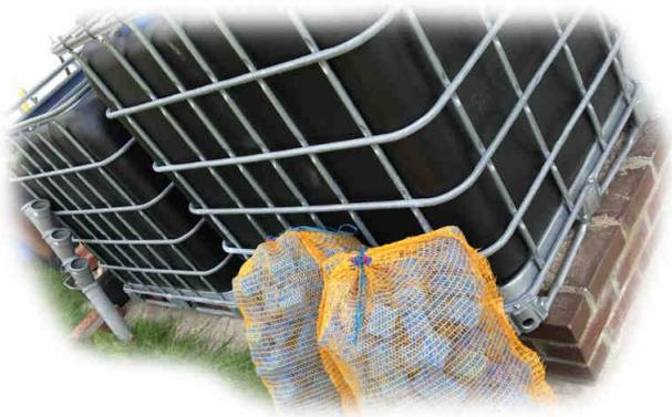
Wenn Sie die **Teichfilteranlage aus 3 IBC Containern bis 300000 Liter** Teichwasser bauen, ist die Befüllung des 3. Tanks die Gleiche wie bei diesem hier. Es geht dabei um die feine Filterstufe für feinste Trubstoffe im Teichwasser und die biologische Filterung durch die Filterbakterien, welche dann die Schadstoffe aus dem Teichwasser abbauen.
