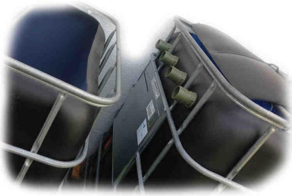
Der Abstand vom oberen Behälter zum Unteren sollte immer so hoch wie möglich sein, damit auch das Wasser eine grosse Fallhöhe bekommt. Dadurch wird der, für die Filterbakterien wichtige Sauerstoff, direkt im Teichfilter ohne zusätzliche Sauerstoffpumpe erzeugt.
