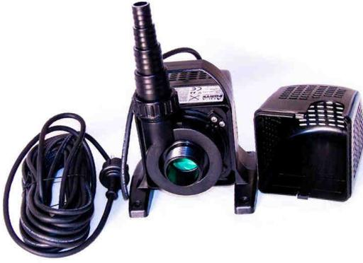
Bei diesem Pumpenmodell können Sie den Pumpenkorb abziehen. Dadurch legen Sie die Saugseite mit Aussengewindeanschluss frei. Somit können Sie einen Schlauchstutzen für den Saugschlauch des Skimmertopfes schnell und sicher montieren. Sie sehen nun selber, dass Skimmer eine hohe Pumpenleistung benötigen und dass man die Skimmeranlage auf keinen Fall mit dem eigentlichen Teichfilter kombinieren sollte.
