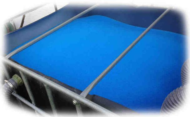
Legen Sie die 3 Filtermatten in den Container ein. Also alle 3 übereinander. Somit haben Sie eine ideale, feine Filtermöglichkeit geschaffen. Wenn Sie Schlitze in die Matten schneiden, können Sie die Überlaufschläuche durch die Schlitze leiten. Dadurch ist auch der Abschluss der Matte zu den Schläuchen gewährleistet. Legen Sie dann flache Steine (z.B. Ziegel) auf die Matten, damit diese nicht auftreiben können. Fertig ist die komplette Bestückung mit Filtermaterialien.
