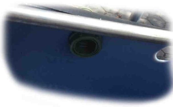
Von innen werden die Anschlüsse mit der Kontermutter gesichert. Dabei erhalten wir eine sehr sichere Verbindung ohne umständlich herumkleben zu müssen. Klebeverbindungen bekommen mit der Zeit Risse und werden undicht. Daher verwenden wir auch keine Klebeflansche usw.
