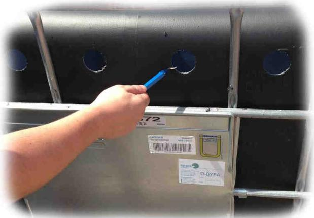
Entgraten Sie die Bohrungen sauber, damit die Dichtungen schön aufliegen können. Entgraten Sie innen und aussen. Wir verwenden dazu immer einen speziellen Entgrater, wie er in der Metallindustrie genutzt wird. Es geht aber auch mit einem Teppichmesser, indem Sie an der Kante der Bohrung entlang schaben, nicht schneiden!
