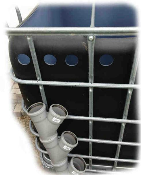
Die Vorbereitungen für den Teichfilter Rücklauf sind nun fast schon fertig. Achten Sie auf jeden Fall darauf, dass Sie diese Lösung mit den Y-Stücken auch so durchführen, um dieses Gebilde wie eine Sauerstoffpumpe zu nutzen. Wir haben diese Art des Rücklaufes absichtlich so erstellt.
