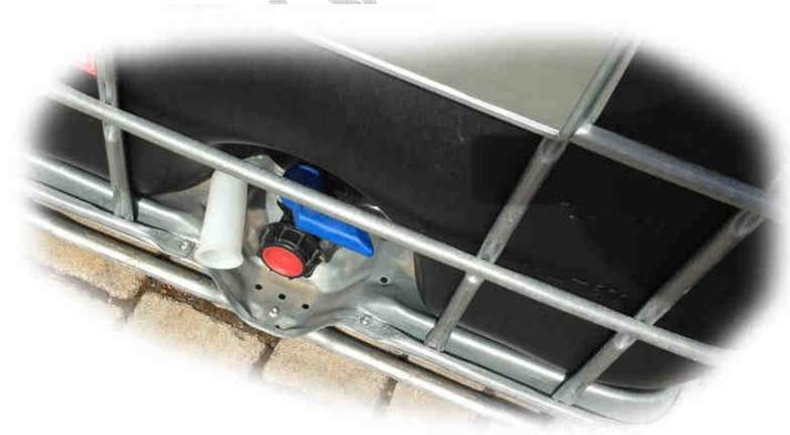
Hier sehen wir den Ablaufhahn am IBC Container. Der weisse Auslaufstutzen war mit dabei. An diesen schliessen wir den Abwasserschlauch an, wenn wir die Behälter später zur Reinigung entleeren. Oftmals erhalten wir Fragen von Kunden, was denn genau für ein Gewinde am Verschluss des Ablaufhahns ist. Dabei handelt es sich je nach Hersteller um ein Spezialgewinde, extra für IBC
