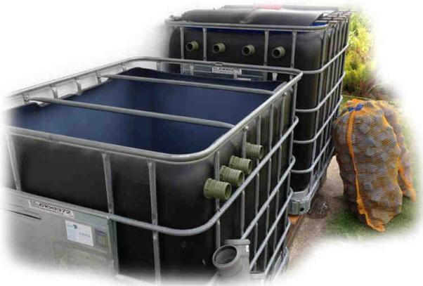
Nun kann man z.B. schon mal die Filterwürfel in die Säcke füllen. Mit mehreren Personen ist das sehr schnell erledigt. Wir nutzen für die 2. Filterkammer immer 600 Liter Filterwürfel in mittelgrober Spezialmischung. Diese ist auch in unserem Shop so erhältlich. Sie erhalten im Shop übrigens auch die kompletten Filtermediensets zu dieser Bauanleitung. Wir befüllen also 6 Kunststoffsäcke mit Würfeln.
