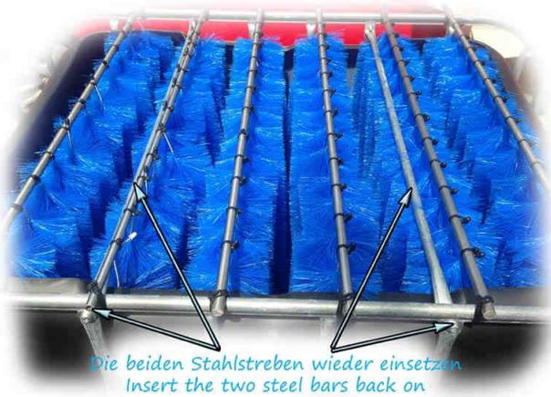
Wenn alle Bürsten im IBC Teichfilter eingehängt sind, müssen Sie die beiden Stahlstäbe wieder anschrauben. Diese hatten wir ja zum Ausschälen der Deckel entfernt. Die Verstrebungen sind später mal ganz wichtig, wenn wir Wasser in den Tank füllen. Somit kann er sich nicht aufblähen.
