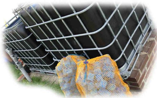
Wenn Sie die **Teichfilteranlage aus 3 IBC Containern bis 300000 Liter** Teichwasser bauen, ist die Befüllung des 3. Tanks die Gleiche wie bei diesem hier. Es geht dabei um die feine Filterstufe für feinste Trubstoffe im Teichwasser und die biologische Filterung durch die Filterbakterien, welche dann die Schadstoffe aus dem Teichwasser abbauen.
