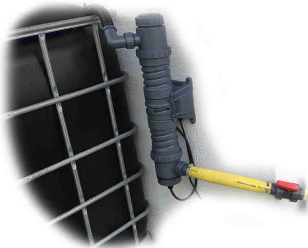
Der Kugelhahn vor dem UV-C Teichklärer ist zum Regeln des Durchflusses gedacht und zum Unterbinden des Rücksogs, wenn man nicht die Lösung mit dem T-Stück nutzen möchte. Der Schlauch von der UVC Lampe läuft im ersten IBC Container bis auf den Tankboden, damit das Wasser auch dort austreten muss, um nach oben durch die Filterbürsten laufen zu können.
