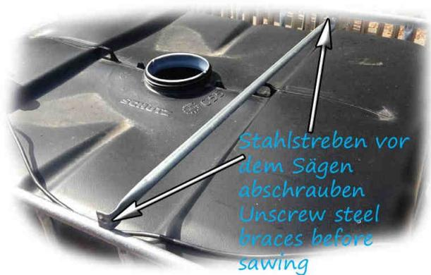
Zuerst müssen wir die Deckel der beiden IBC Container aufsägen. Dazu verwenden wir eine Stichsäge mit feinem Blatt. Also am Besten das Sägeblatt für Metall nutzen, da dieses nicht so sehr "rupft". Vor dem Sägen müssen Sie aber die beiden Metallstreben, falls an Ihrem Container vorhanden, abschrauben. Diese brauchen wir später aber wieder, also nicht wegwerfen!
