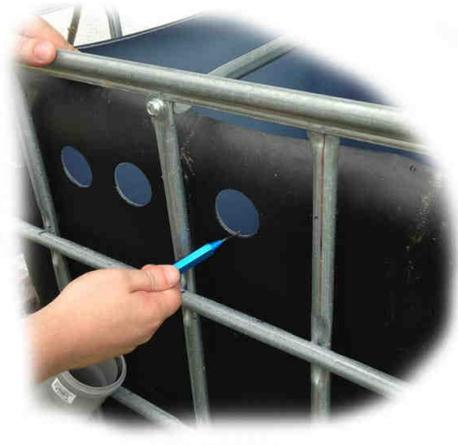
Wenn Sie die Löcher gebohrt haben, entgraten Sie diese wieder wie bei dem ersten IBC Behälter. Somit kann die Dichtung der Anschlüsse wunderbar anliegen. Das machen Sie innen und aussen. Die Löcher zu bohren, geht eigentlich von allen Arbeitsschritten am schnellsten beim Teichfilterbau.
