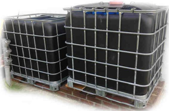
Der Höhenunterschied von einem Tank zum Anderen darf ruhig 20 cm oder mehr betragen. Je mehr, desto besser. Denn desto höher platscht das Wasser in den Überlaufschläuchen nach unten in den nächsten Tank und erzeugt somit auch mehr Sauerstoff. Wie bei einem Wildbach mit Staustufen. Die Filterkammern alle auf der gleichen Höhe zu platzieren geht bei diesen Biofiltern überhaupt nicht, da dann alles, wie in einer unbeweglichen Brühe, in den Behältern liegt.
