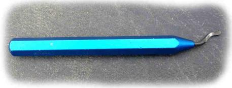
Mit diesem Entgrater ist ein professionelles Entgraten möglich. Da diesen aber nicht jeder zu Hause hat, gehen auch eine Rundfeile oder ein Teppichmesser. Es ist wichtig dass der Grat entfernt wird, damit die Dichtungen der Teichfilteranschlüsse schön aufliegen und dicht sind.
