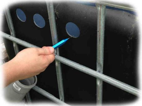
An diesem Beispiel sehen Sie, wie die Bohrungen angebracht und entgratet werden. Das ist hier bei einem IBC Container für Teichfilter der Fall. Eine Bauanleitung über Filteranlagen aus IBC Tanks finden Sie übrigens als eigenes Kapitel in unseren Anleitungen. Dazu haben wir auch Videos für Sie bereitgestellt.
