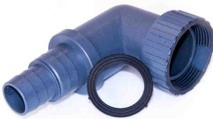
Dieser Winkelanschluss aus unserem Shop ist vor allem für die Sera Pond PP Precision Pumpen geeignet. Wenn die gerade Schlauchtülle nach oben über die flache Pumpe läuft, macht der Teichschlauch einen sehr unschönen und weiten Bogen über die Pumpe. Damit können Sie den Schlauch aber schön flach über die Pumpe weglaufen lassen. Durch die lose Überwurfmutter können Sie den Anschluss um 360 Grad drehen. Somit können Sie immer die richtige Seite zum Teichfilter hin ansteuern.
