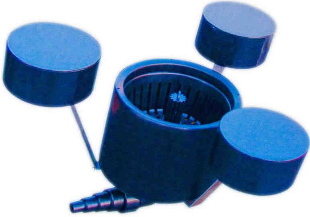
Durch die 3 Schwimmkörper passt sich der Skimmerkorb immer dem aktuellen Teichwasserniveau an. Ist der Korb voll, steigt dieser nach oben und verhindert, dass das Laub wieder aus dem Korb entweichen kann. Wenn man die Skimmeranlage in Betrieb hat sollte man sich immer in der Nähe des Teiches befinden, um gleich, bei einem vollen Skimmertopf, reagieren zu können.
